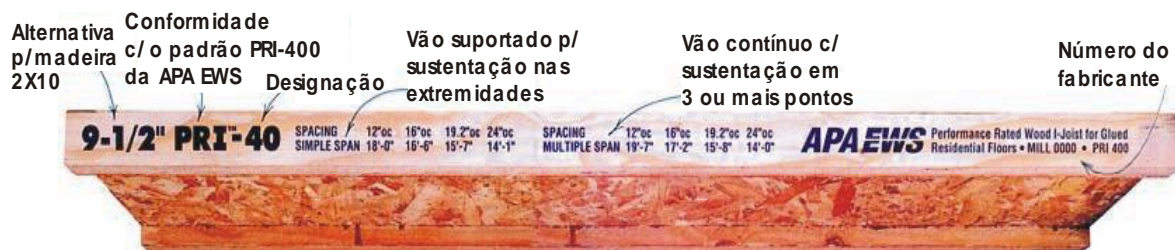
FIGURA 3 – PADRONIZAÇÃO DE VIGA “T”
