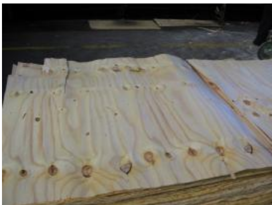
Exemplo de lâminas descartadas por distância entre nós e rachadura de topo.
